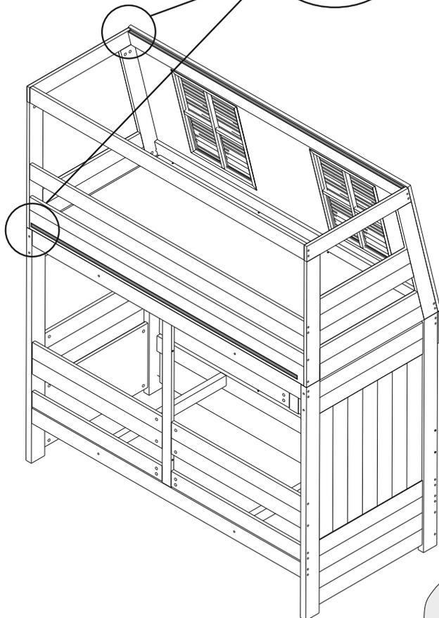
**Шаг 1** Снимите защитный слой с липучки и приклейте к крыше, как показано на рисунке.
