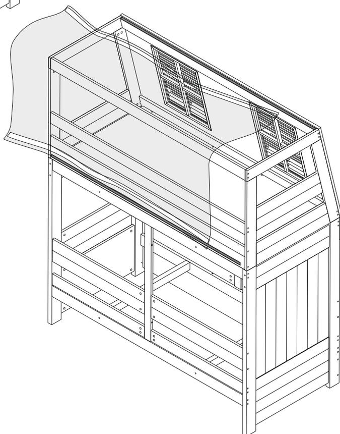
**Шаг 2** Закрепите ткань сначала на верхней стенке крыши, распределите равномерно по всей поверхности и зафиксируйте вторую сторону.
